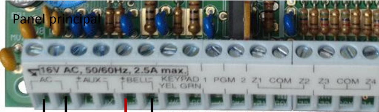
Use el cable de alarma uniendo dos cables para señal **BELL +** y dos para **BELL -**
