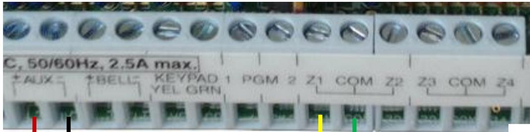
Se usa de ejemplo conexión a la terminal Z1
